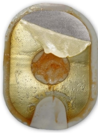
Afbeelding 2: losgelaten, omgevouwen gel kan er ook verkleurd en/of gesmolten uitzien.
