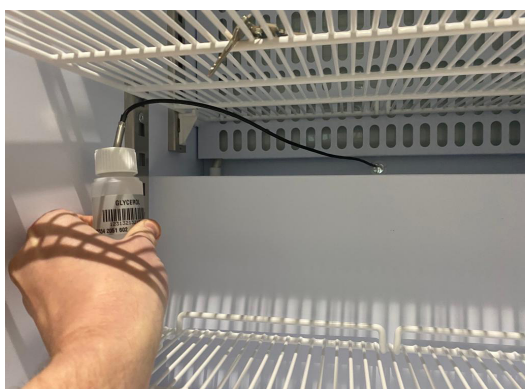
4. Plaats de sensor in een glycerolflesje en bevestig deze aan de zijkant van de koelkast/vriezer
